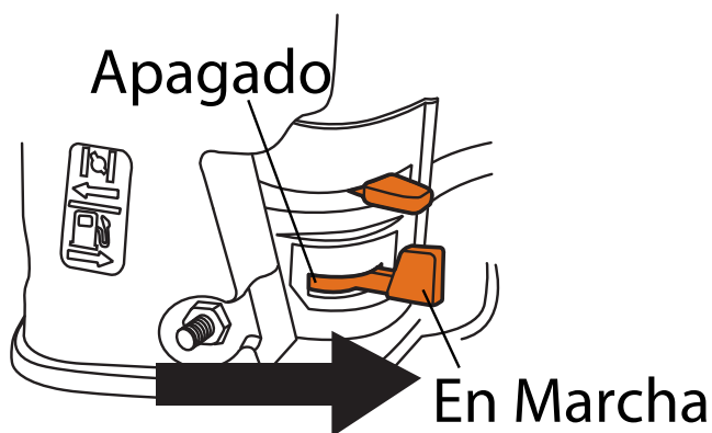
Figura 21 - Válvula de combustible
